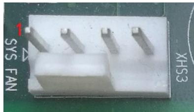
表 2.22: CPU/系统风扇接口信号定义 (XHS1、XHS2、XHS3、XHS4)
