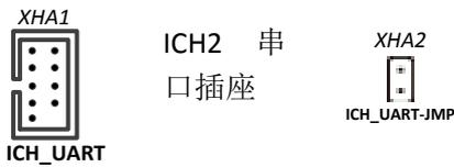
对 ICH 串口功能进行设置：连接跳线，可通过串口对 ICH2-FLASH 进行编程；不接跳线，作普通 uart 串口使用
